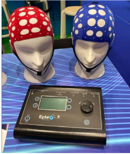
Ilustración 20. Cascos de tDCS y equipo generador de corriente Epte®
