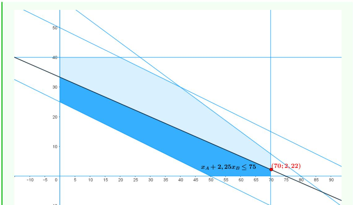
Figura 5.9: Método de la restricción. Soluciones Eficientes, espacio de variables de decisión.
