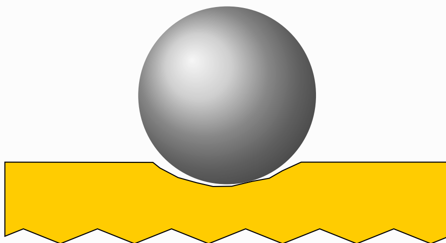
Figura 3.2: Idealización del perfil del plano con el canal semicircular. Galileo cuenta que «este canal, tallado lo más recto posible, se había hecho enormemente suave y liso, colocando dentro un papel de pergamino lustrado al máximo». Esta observación me hace pensar que ese canal «de poco más de un dedo de anchura» debió presentar un perfil curvado obtenido con una gubia de corte curvo. Este perfil intentaría facilitar, en lo posible, una sola zona de contacto entre bola y plano.
