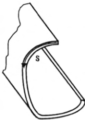
Figura 13.3. Perfil abierto. Coordenada natural.
