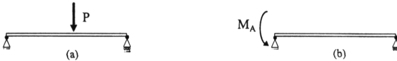
Figura 10.6. Descomposición del problema 10.5.c. en dos problemas isostáticos: a) con las cargas externas, b) con la reacción vincular como carga externa.
