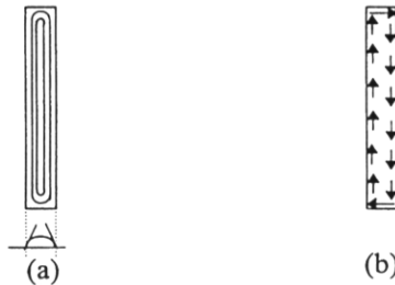
Figura 13.26. Rectángulo con una dimensión mucho menor que la otra: curvas de nivel de la deformada de la membrana a) y tensión tangencial en torsión b).
