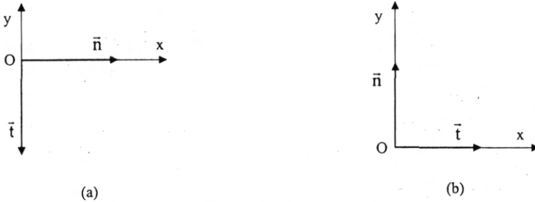
Figura 2.21. Vectores unitarios normal y tangencial cuando el vector normal coincide con el eje OX, (a) y cuando el vector normal coincide con el eje OY, (b).
